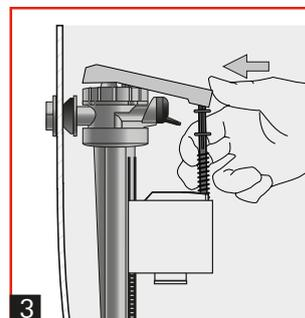
► Cette tête rotative à 90° se positionne même dans les petits coins et évite tout contact entre le robinet et le mécanisme. Ceci est particulièrement appréciable dans les céramiques notamment les plus étroites.
